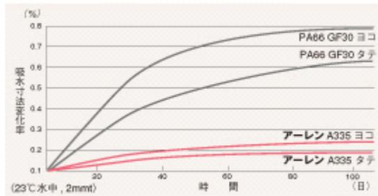
吸水率の寸法変化，属于在聚酰胺类最低，低于 PA66 的 1/2。
