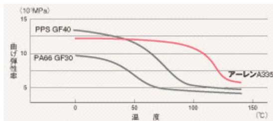
由于它具有（125℃），即使在高温下的气氛，如在机房，你可以保持高刚性高玻璃化转变点。
